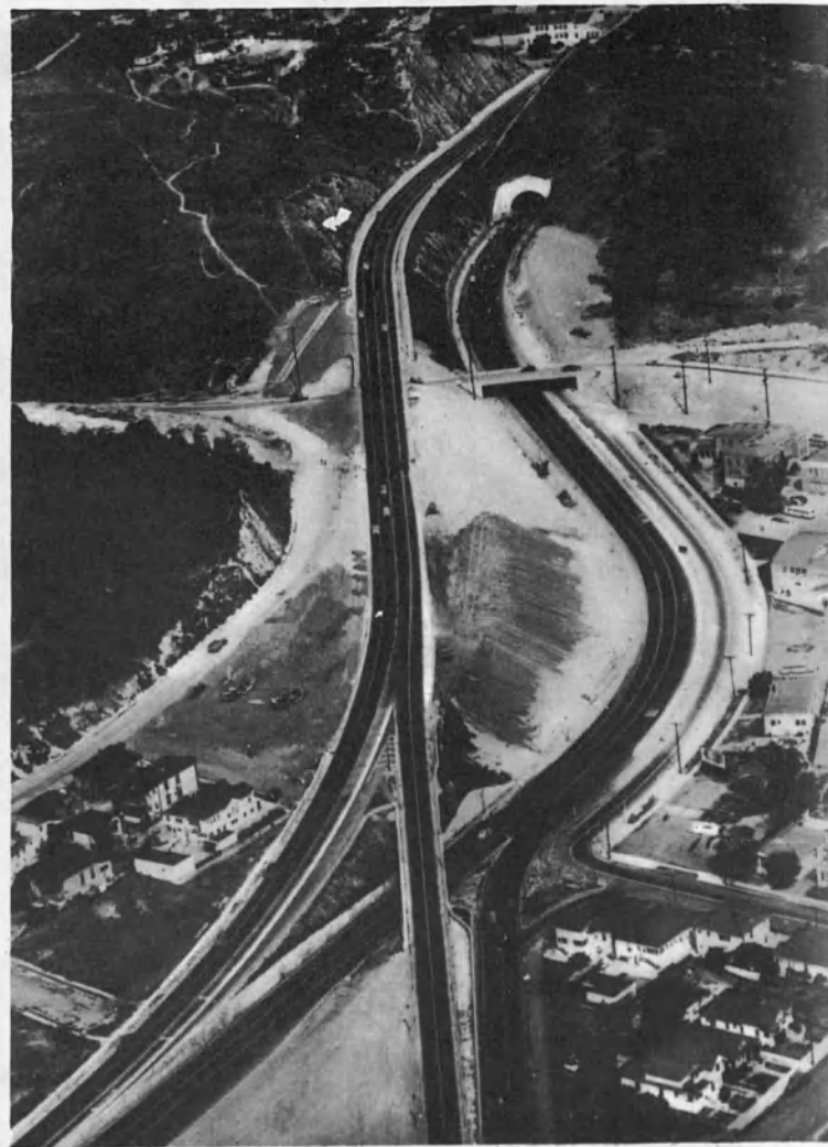
ESLABONES DEL TRÁFICO. Cerca de Detroit, en Michigan, estas dos autopistas —una con doble línea de tránsito y otra a lo largo del Lago Michigan— están enlazadas por rampas y pasos subterráneos. Este sistema facilita el tráfico a gran velocidad y elimina las intersecciones peligrosas:
