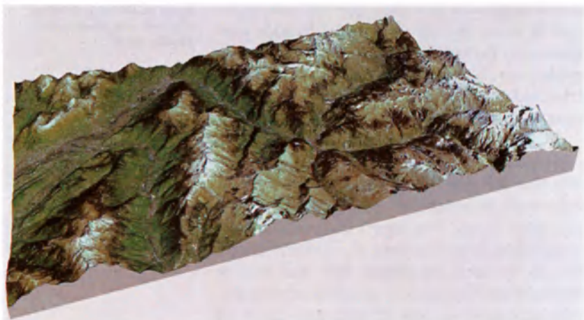
Foto superior, imagen tomada por el satélite SPOT de Albertville (Francia), lugar donde se realizarán los Juegos Olímpicos de Invierno de 1992. A partir de una base de datos altimétricos, un modelo numérico de terreno permite representar los relieves mediante una cuadrícula deformada (al medio), que basta combinar con la imagen Spot para obtener una imagen en perspectiva (arriba).
