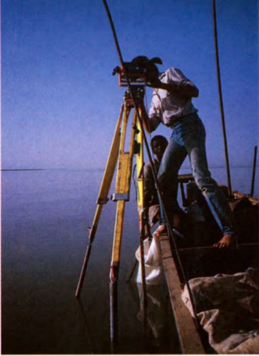
Instalación de un punto geodésico sumergido.
