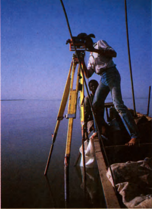
Instalación de un punto geodésico sumergido.
