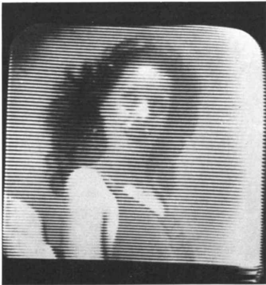
Sobre la pantalla de televisión las líneas, formadas por puntos, que constituyen la imagen se reúnen en apretado haz. Aquí se han separado expofeso, para poder mostrar mejor sus características individuales. (Foto USIS).
