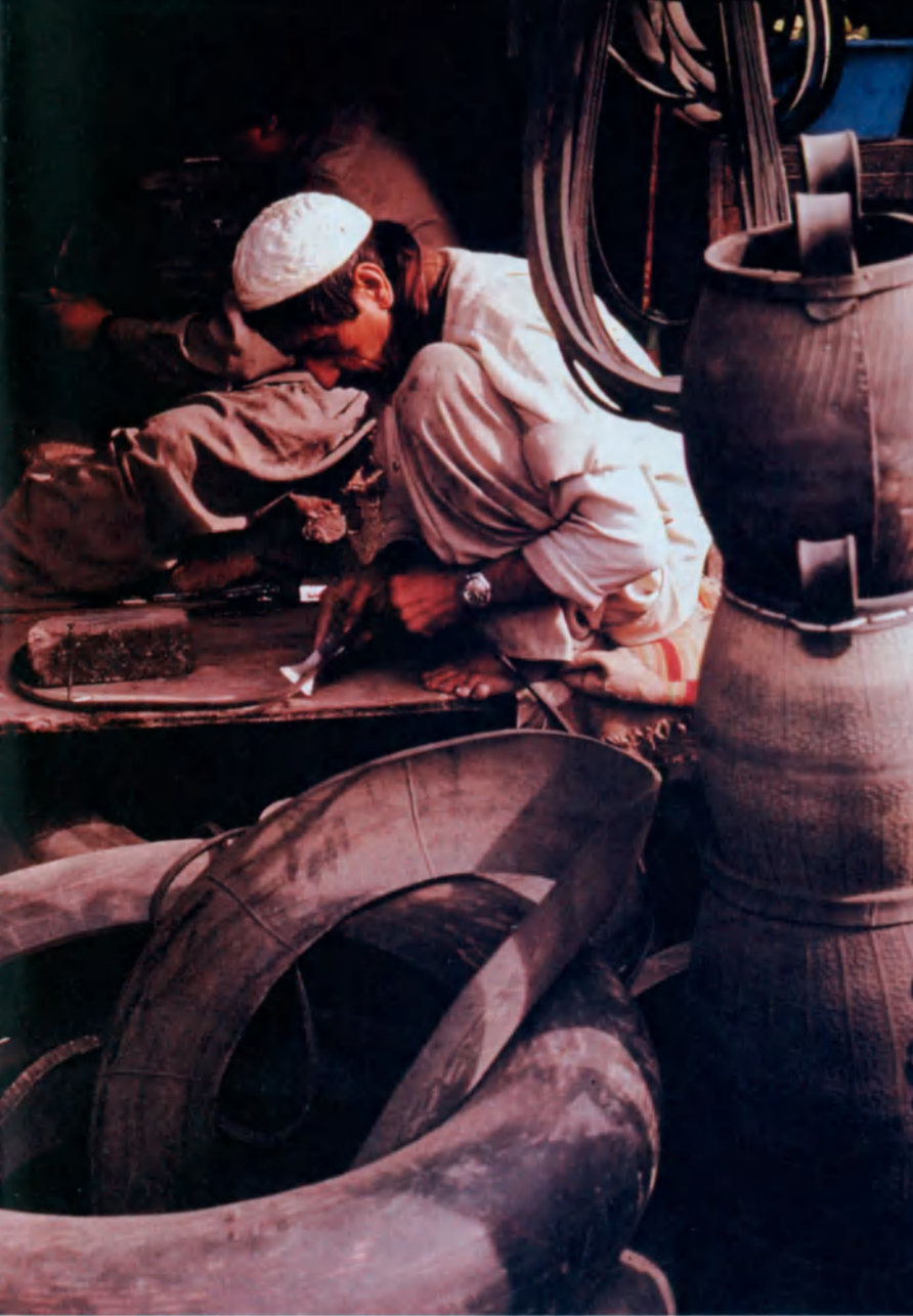
F abricación de sellos a partir de neumáticos usados en Peshawar (Pakistán).
