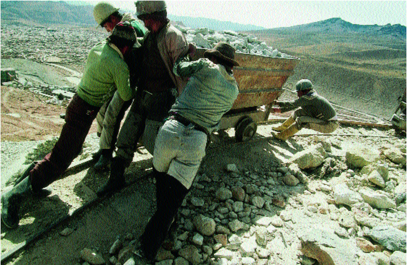
A tracción humana. Se requiere la fuerza de varios hombres para arrastrar el mineral desde la "bocamina" al ingenio donde se tritura la roca extraída. Los mineros de Rosario Bajo empujan el contenedor sobre unos rieles en mal estado.
