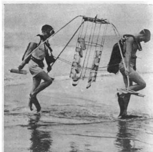
Recuperación de un armadizo para recoger sedimentos en el fondo del océano. Este aparato sirve para el estudio de la formación de las playas. (USIS).
