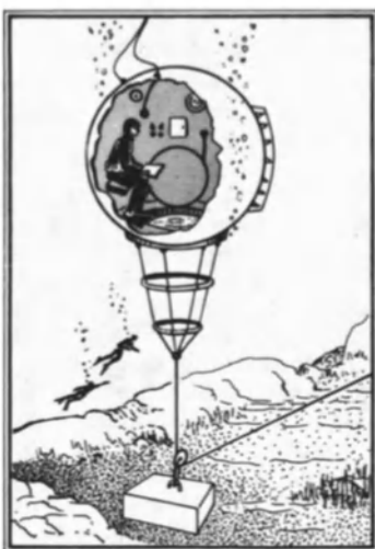
CAMARA DE DESCOMPRESION. Esfera de acero, de unos dos metros de diámetro, en la que pueden entrar cuatro buceadores por una escotilla de fondo y tomar notas o comunicarse telefónicamente con la tripulación durante el lento proceso de descompresión.
