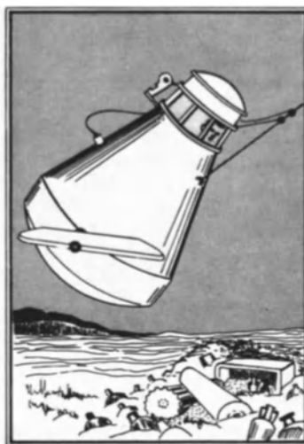
CABINA DE OBSERVACION. Artefacto de acero remolcado por una barcaza. El piloto puede mirar a todos lados gracias a una ventanilla circular de plexiglás y controlar el rumbo de la cabina manejando las aletas laterales. Se ha utilizado en profundidades de 100 metros y resulta especialmente útil para la exploración en aguas claras.
