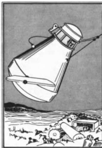
CABINA DE OBSERVACION. Artefacto de acero remolcado por una barcaza. El piloto puede mirar a todos lados gracias a una ventanilla circular de plexiglás y controlar el rumbo de la cabina manejando las aletas laterales. Se ha utilizado en profundidades de 100 metros y resulta especialmente útil para la exploración en aguas claras.
