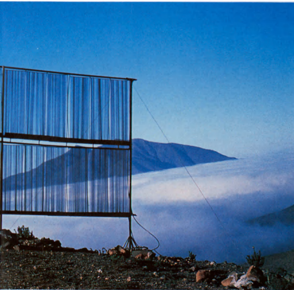
“Camanchacas”, dispositivo de origen andino que consiste en mallas de gran dimensión destinadas a captar el vapor de agua de las nubes o las neblinas. Su eficacia ha quedado demostrada y comienza a utilizarse en otras regiones (India, países del Golfo pérsico).
