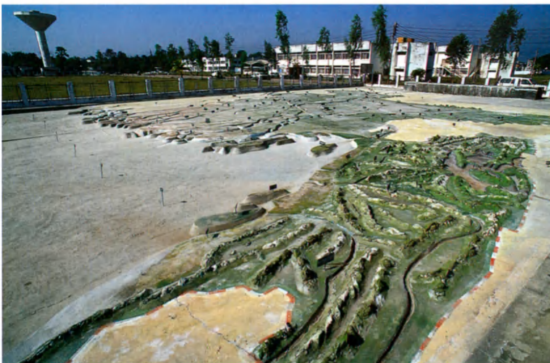
Estanque de simulación del Centro de Investigación de Faridpur, Bangladesh, donde se estudia la circulación de las aguas en caso de inundación, antes de iniciar la construcción de diques.
