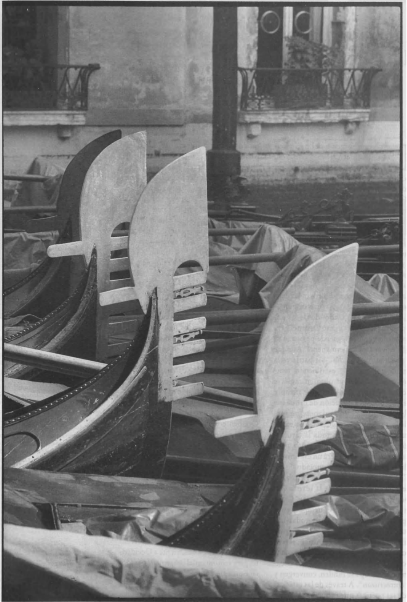
Para hacer contrapeso al gondolero que se instala junto a la popa, la góndola lleva en la proa una pesada plancha de acero con seis "dientes" que se dice simbolizan los seis barrios históricos de Venecia, mientras la cimera de metal que la corona representa al parecer el sombrero ritual de los Dogos.
