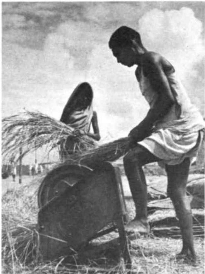
Esta batidora a pedal separa los granos de arroz de la paja.
