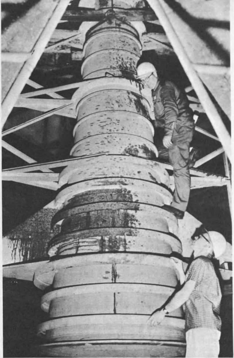
Arriba, los técnicos inspeccionan en el barco que hizo la perforación de prueba el tubo protector de la cañería de perforación, tubo que limita la combadura de que pueda ser objeto esa cañería cerca de la superficie. En el curso de la perforación el piloto del barco tuvo que mantenerlo en el centro de un anillo de boyas. Si las olas lo hubieran empujado fuera de ese círculo, el perforador se habría roto violentamente. Abajo, los científicos examinan los primeros cilindros de roca extraídos a trescientos metros bajo el lecho oceánico.
