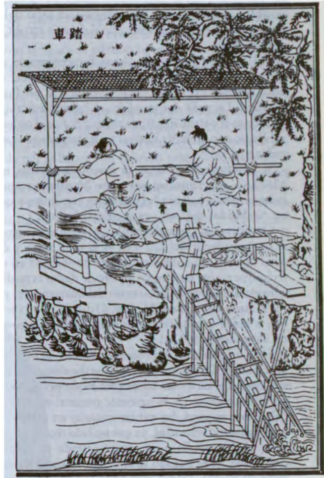
Este grabado en madera de 1637 representa a dos hombres moviendo con su pedaleo una noria de arcaduces utilizada para el riego.
