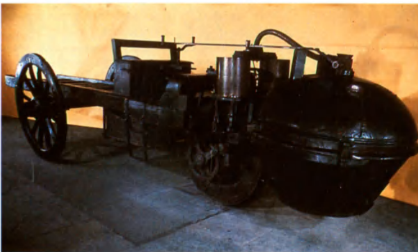
El primer vehículo capaz de recorrer una distancia por sus propios medios: el triciclo movido a vapor inventado en 1771 por el ingeniero francés Nicolas Joseph Cugnot.
