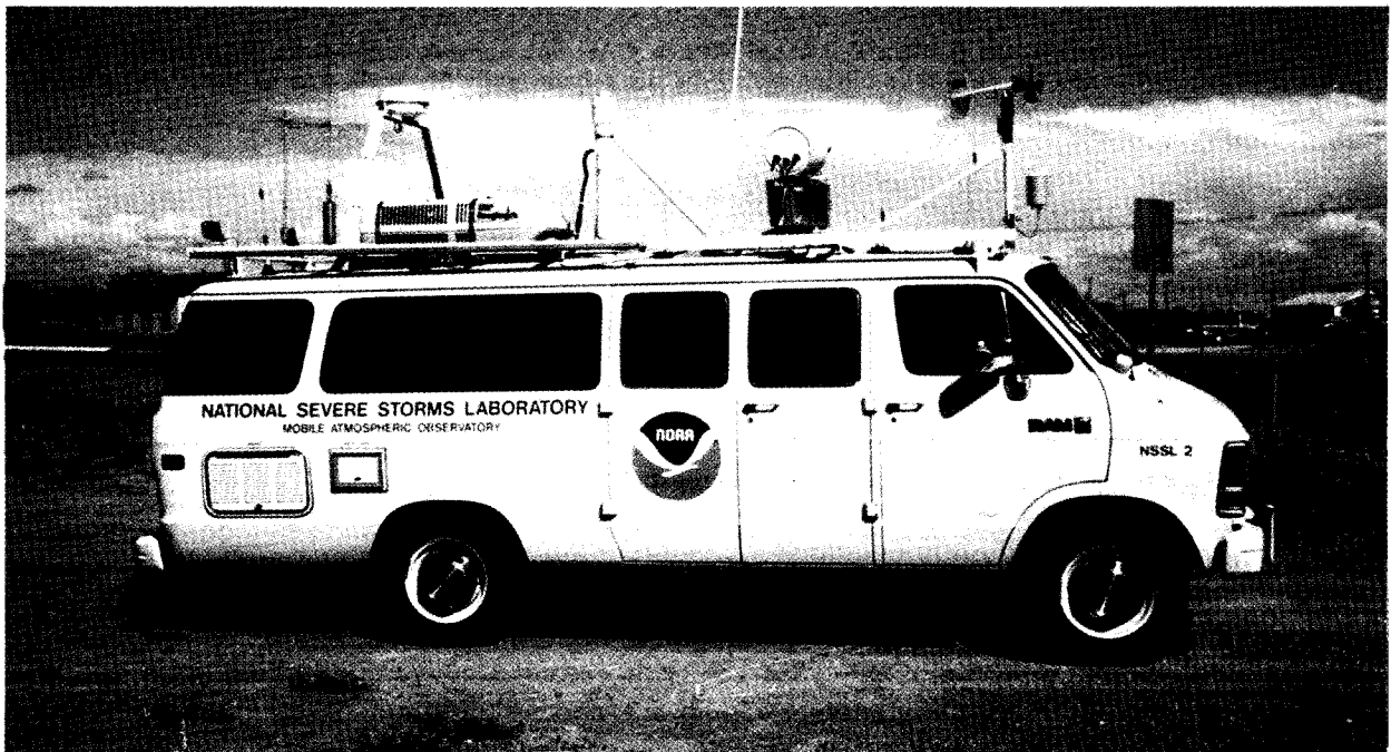
Fig. 3. Unidad móvil para observaciones meteorológicas de altura y superficie (sistema móvil MCLASS).
