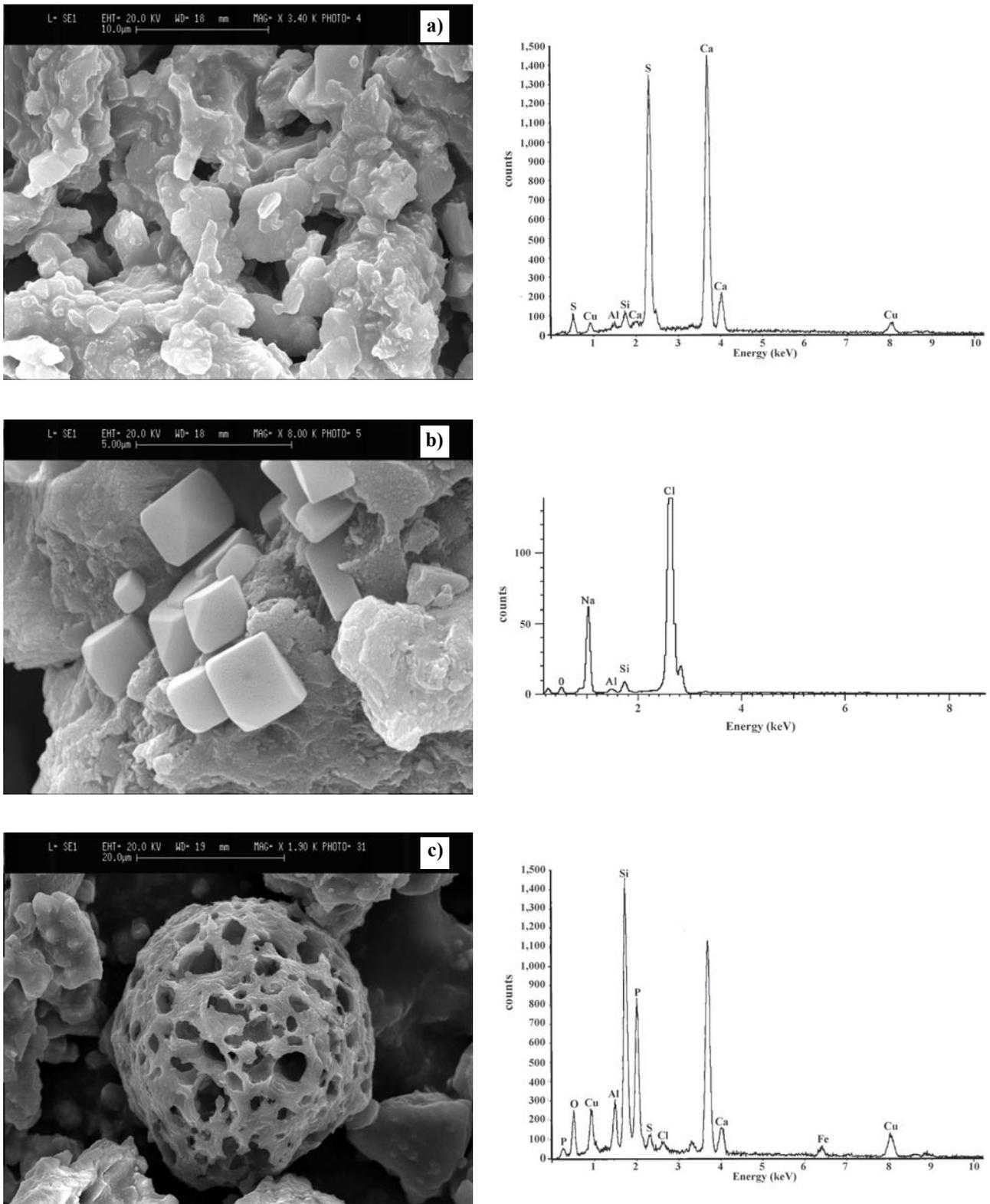
Figura 3. Fotomicrografías de MEB y determinación de componentes en una partícula: a) cristales de yeso:  $\text{CaSO}_4 \cdot 2\text{H}_2\text{O}$  (M-1); b) cristales de halita:  $\text{NaCl}$  (M-10); c) esferas de fosfato de calcio (M-6).
