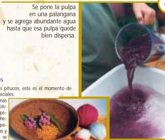
Se pone la pulpa en una palangana y se agrega abundante agua hasta que esa pulpa quede bien dispersa.
