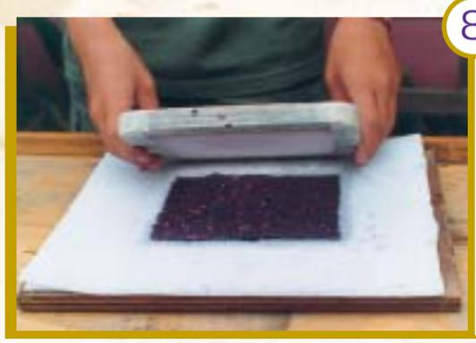
Se invierte el molde con la hoja de pulpa recién formada sobre la tela, previamente colocada sobre una de las maderas, y se retira el molde.
